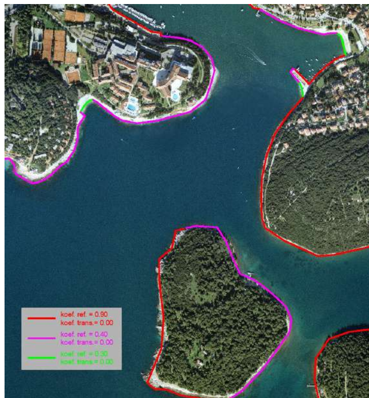
Slika: Koeficijenti refleksije detaljnih numeričkih simulacija
